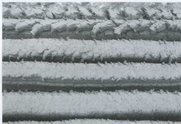
Рис. 3. Свежесформованная торфяная лента с признаками нарушения целостности куска (кольцевое «ершение»)
