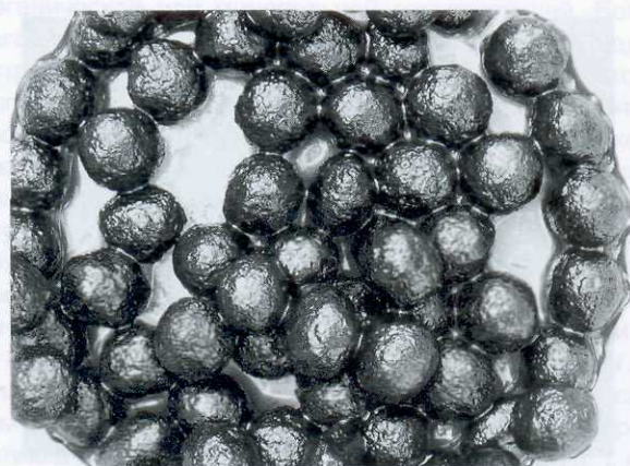
Рис. 4. Сорбция разлива нефтепродуктов на поверхности водоема гранулированным композиционным сорбентом на основе торфа
