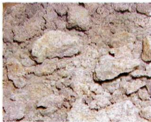
Рис. 9. Контрольный образец портландцемента М-500 после хранения его во влажных условиях ( \varphi = 100\% ) в течение 3 лет
