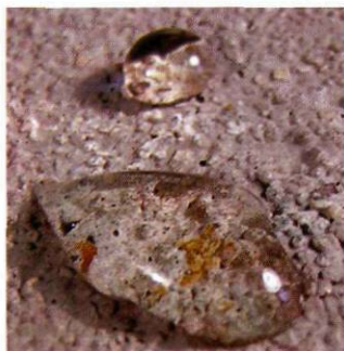
Рис. 12. Капли воды на поверхности образцов, изготовленных на основе гидрофобизованного портланд-цемента
