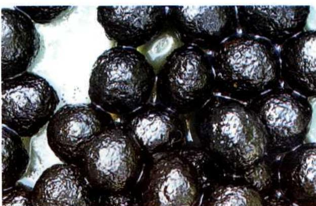
Рис. 7. Образцы торфяного сорбента после поглощения нефтепродуктов
